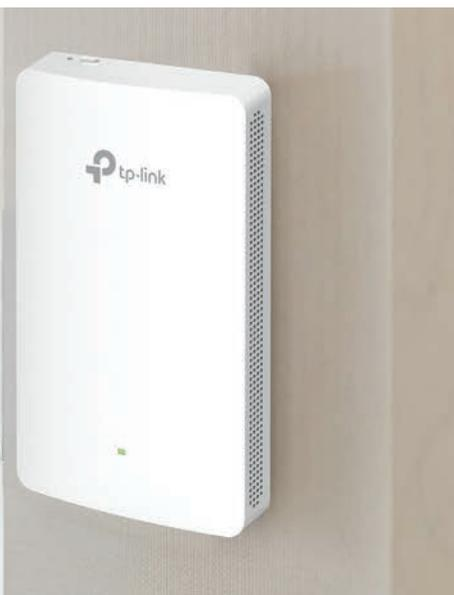
Installazione di un **Access Point Wall** all'interno della camera, per connessioni wireless via cavo per Smart TV, telefoni VoIP, computer e altri dispositivi
